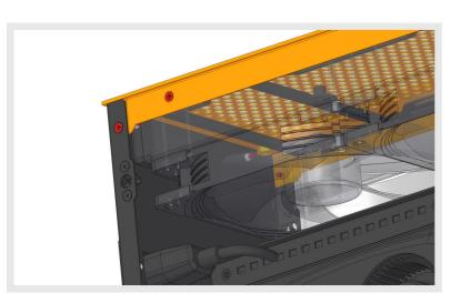
THE JOGGLED TABS ON EITHER SIDE OF THE BACK END OF THE TOP MUST BE SET INSIDE THE CASE FRAME.
